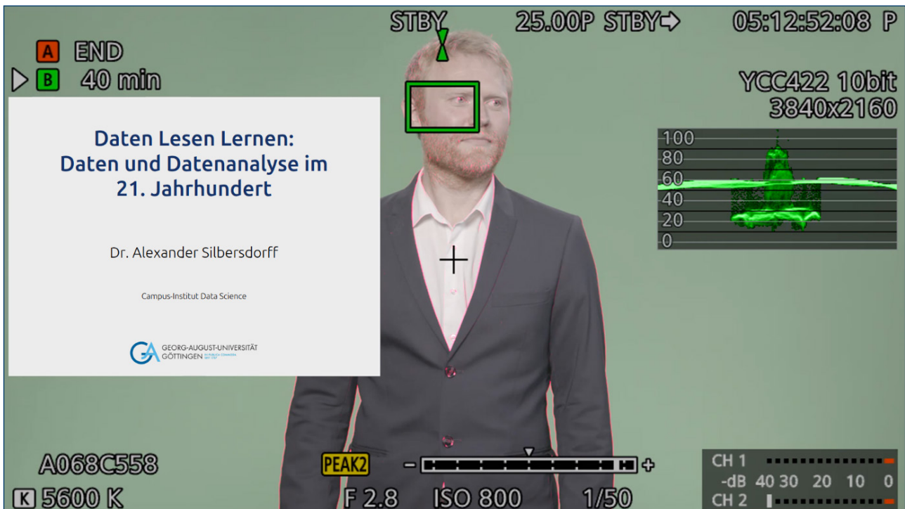
Abbildung 5: Beispiel eines technischen Kamerabilds. Die Anzeigen erlauben die Überprüfung der aufnahmetechnischen Parameter wie Tonpegel, Belichtung und Fokus.
