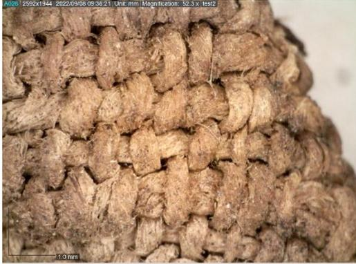
**Abbildung 48: Gewebe in Leinwandbindung.**
