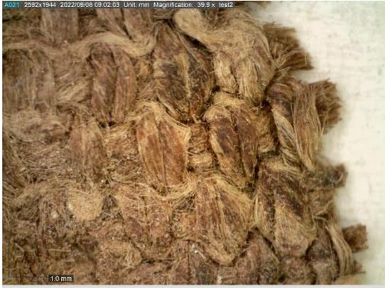
**Abbildung 43: Gewebe in abgewandelter Leinwandbindung (Panamabindung).**
