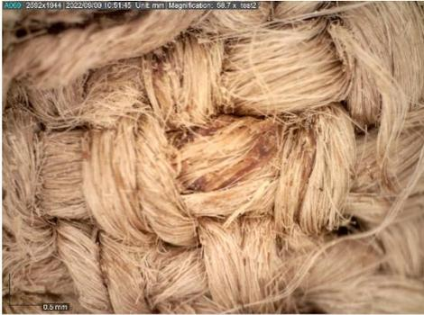
**Abbildung 32: Gewebe in abgewandelter Leinwandbindung (Panambindung).**
