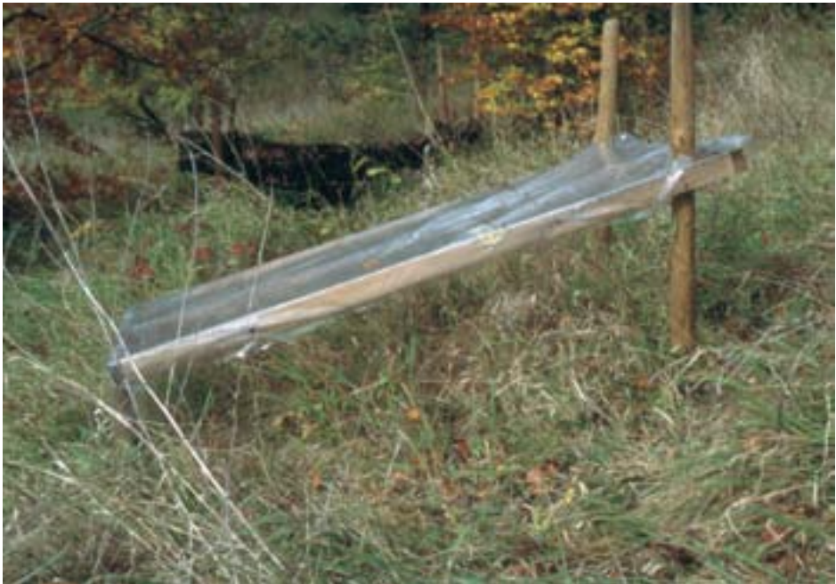
Abb. 23: Reduktion des Niederschlags mit einem lichtdurchlässigen Regendach
