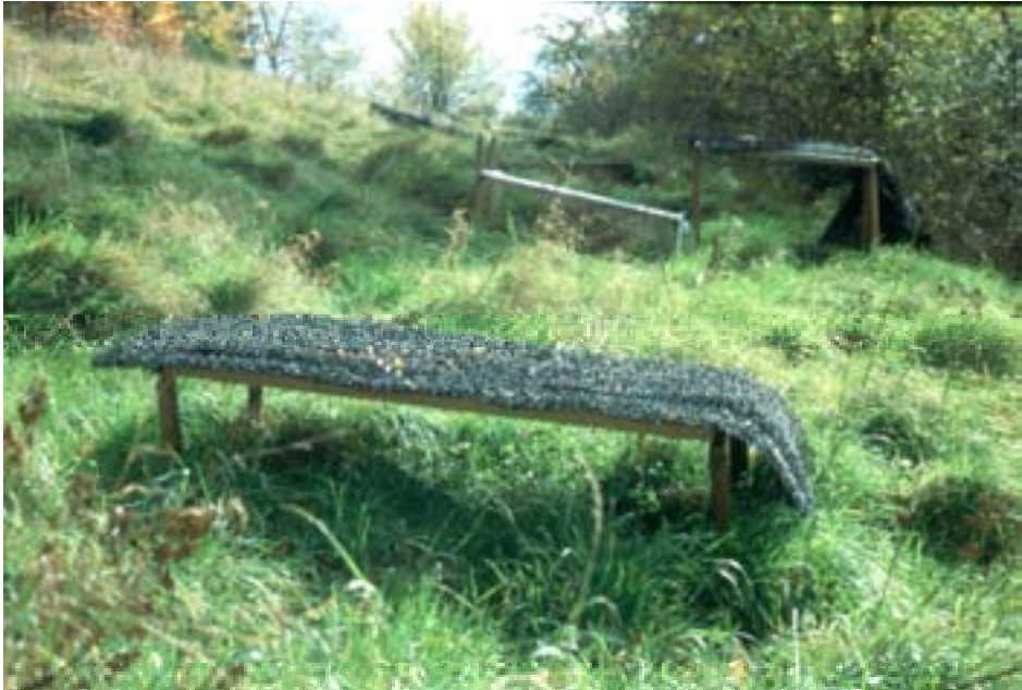
Abb. 22: Reduktion der Sonneneinstrahlung mit einem regendurchlässigen Schattendach.
