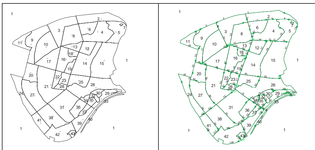
Abbildung 4.4-6. Beispiel der Arc/INFO Polygon-Centroiden and Polylinien in einem Revierteil.
