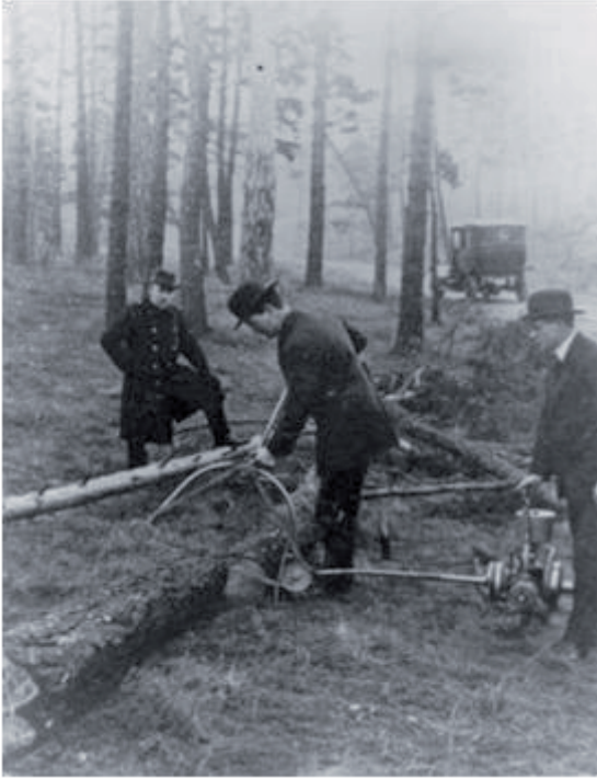
Abbildung 45: Die in Schweden entwickelte ‚Baumfällmaschine Sector‘ war die erste Motorsäge, die im Wald einsetzbar war. Die Aufnahme stammt aus Schweden von ca. 1917. Deutlich sichtbar ist die schwenkbare Schneidegarnitur, die die Säge an stehendem und liegendem Holz einsetzbar machte. 816
