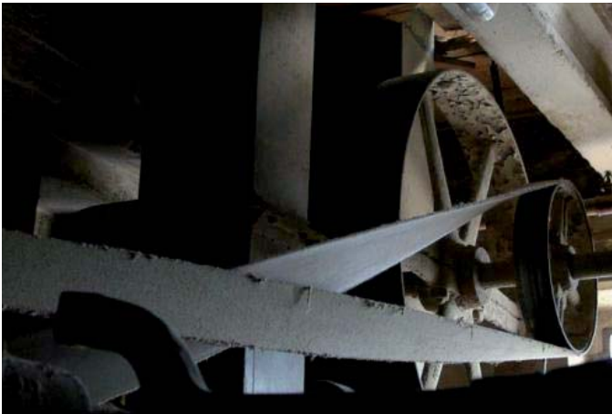
Abbildung 20: In Fabriken verbanden lederne Treibriemen den zentralen Motor mit den einzelnen Maschinen. 205 206
