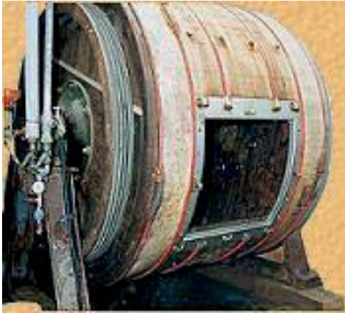
Abbildung 10: Das Gerbfass ähnelt einer modernen Waschmaschinentrommel. Die Gerbextrakte wurden in der gewünschten Zusammensetzung über die Zentralachse eingespritzt. Durch die gleichmäßigere und wegen der Zentrifugalkraft schnellere Durchdringung der Häute reduzierte sich die Gerbzeit auf nur noch 4–6 Wochen. 135
