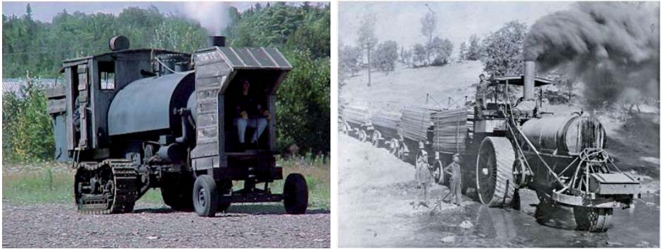
Abbildung 29: Dampflok mit Gleiskettenantrieb und Frontlenkung (links) und Lokomobil beim Holztransport (rechts) 384
