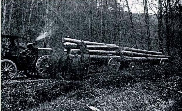
Abbildung 41: Holztransportzug mit 16-PS-Motor (Gasmotorenfabrik Deutz) mit zwei Langholzanhängern. 788
