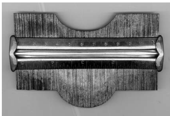
Abbildung 2.1: Ein Konturtaster, hier mit einer bogenförmigen Kontur.
