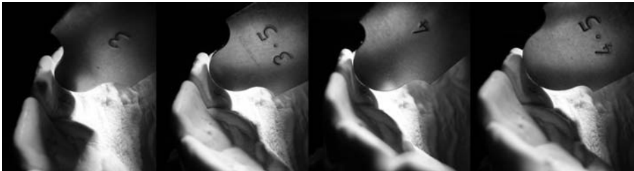
Abbildung 2.9: Radienlehren in Aktion am Abdruck eines menschlichen Oberkiefers. Der 3-er Radius berührt den Frontzahn nur in einem Punkt und ist daher zu klein, der 4-er und erst recht der 4.5-er berühren die Kontur in zwei Punkten und sind zu groß. Am Besten passt der 3.5-er Radius mit vielleicht einer Tendenz zu größeren Werten.
