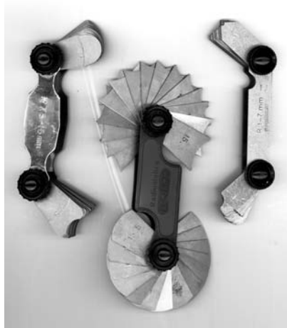
Abbildung 2.8: Drei handelsübliche Radienlehren. Die Abstände und ihre Abstufungen sind: 1–3(0.25) 3.5–7(0.5)mm, 7.5–15(0.5)mm und 15.5–20(0.5) 21–25(1)mm.
