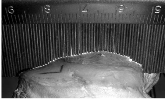
Abbildung 2.2: Der Konturtaster in Aktion, hier am konvexen Sagittalschnitt des lateralen Kompartimentes eines Abgusses einer menschlichen Tibia.
