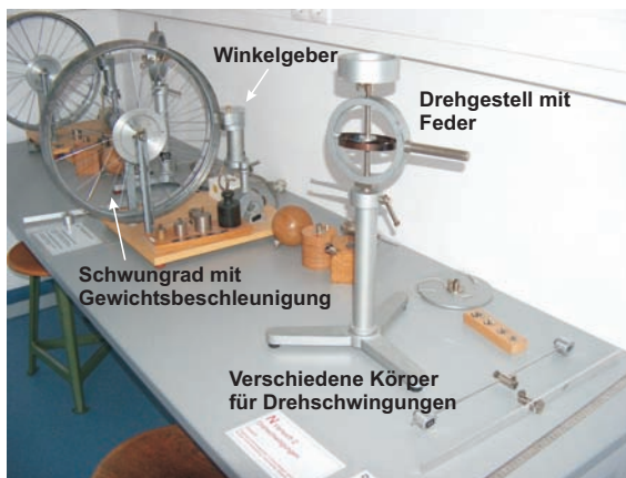
Bild 3.1: Versuch Messung von Trägheitsmomenten verschiedener Körper.
