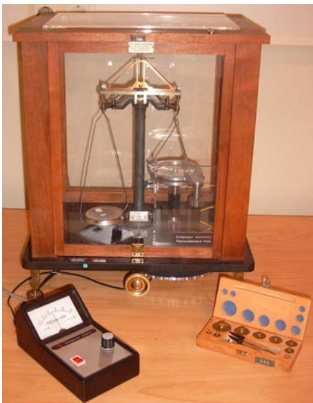
Bild 10.1: Der Versuch »Potenzialwaage« mit Schema.
