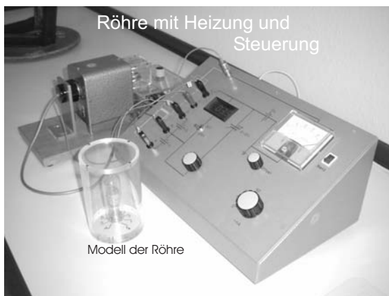
Bild 22.1: Der »Franck-Hertz-Versuch« mit Quecksilber.
