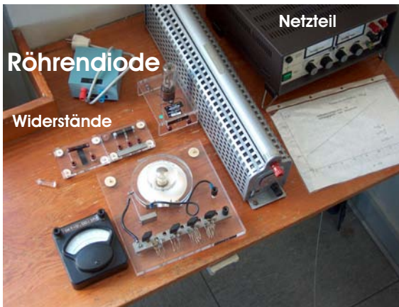
Bild 17.1: Ein Bild des Versuchs »Diode«.
