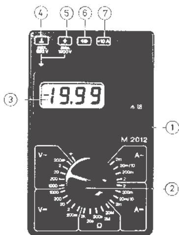
Bild E.1: Darstellung des im Praktikum verwendeten Digital-Multimeters M2012 (Messgerät für elektrische Spannung, Strom und Widerstand).
