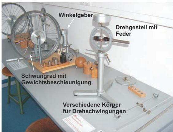
Bild 2.1: Versuch Messung von Trägheitsmomenten verschiedener Körper.
