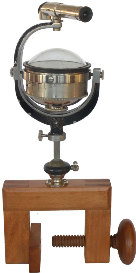
Abb. 2. Ballonkompass von Karl Schwarzschild, 1909. Bei einem Ballonflug ist nachts oder bei Dunst der Erdboden nicht sichtbar. Um in diesen Fällen trotzdem die Geschwindigkeit des Ballons über Grund und die Flugrichtung bestimmen zu können, wird das Magnetfeld der Erde benutzt, das mit einem speziellen Kompass an Bord gemessen wird. Ein von Karl Schwarzschild entwickelter Ballonkompass wurde auf der 1. Internationalen Luftfahrt-Ausstellung („Ila“) in Frankfurt 1909 ausgestellt. Die mittels Kompass erreichbare Ortsgenauigkeit beträgt etwa \pm 10 km (Sammlung historischer Gegenstände am Institut für Astrophysik der Georg-August-Universität Göttingen, Objekt Nummer A184, Foto: K. Reinsch).
