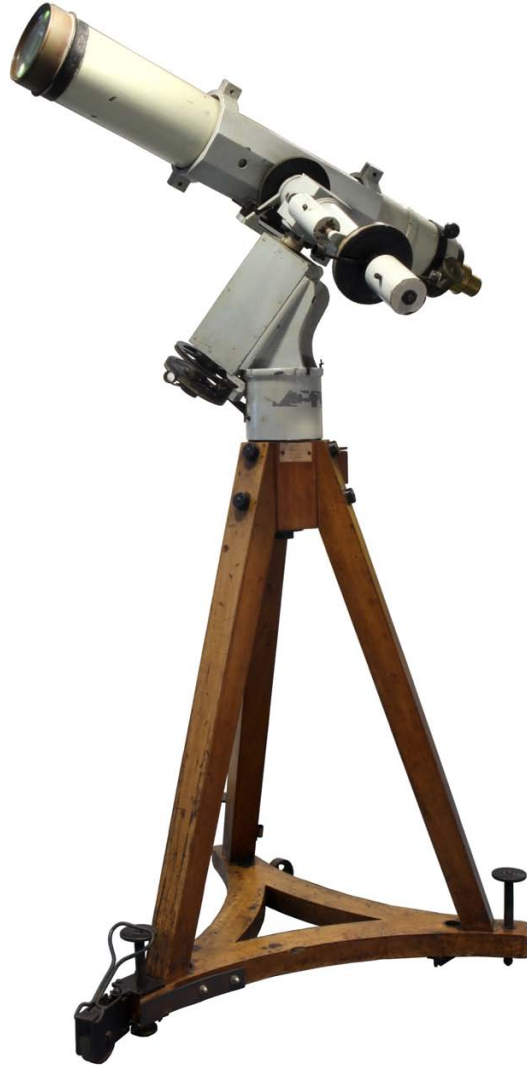
Abb. 11. Kometensucher von Georg Merz München, Mitte 19. Jahrhundert. Kometensucher sind besonders lichtstarke Fernrohre mit großer Öffnung aber relativ kurzer Brennweite, die zur Beobachtung lichtschwacher, flächenhafter Objekte wie Nebel, Galaxien oder Kometen verwendet werden. Der ca. Mitte des 19. Jahrhunderts von der Firma Georg Merz (1793–1867) in München hergestellte Kometensucher auf einer parallaktischen Montierung war mit einer Objektivöffnung von 16 cm und einer Brennweite von 136 cm noch zur Zeit von Schwarzschild eines der größten Fernrohre der Göttinger Sternwarte. Das ursprüngliche eiserne Stativ wurde vermutlich bereits Ende des 19. Jahrhunderts durch das jetzige Holzstativ ersetzt (Sammlung historischer Gegenstände am Institut für Astrophysik der Georg-August-Universität Göttingen, Objekt Nummer A102, Foto: K. Reinsch).
