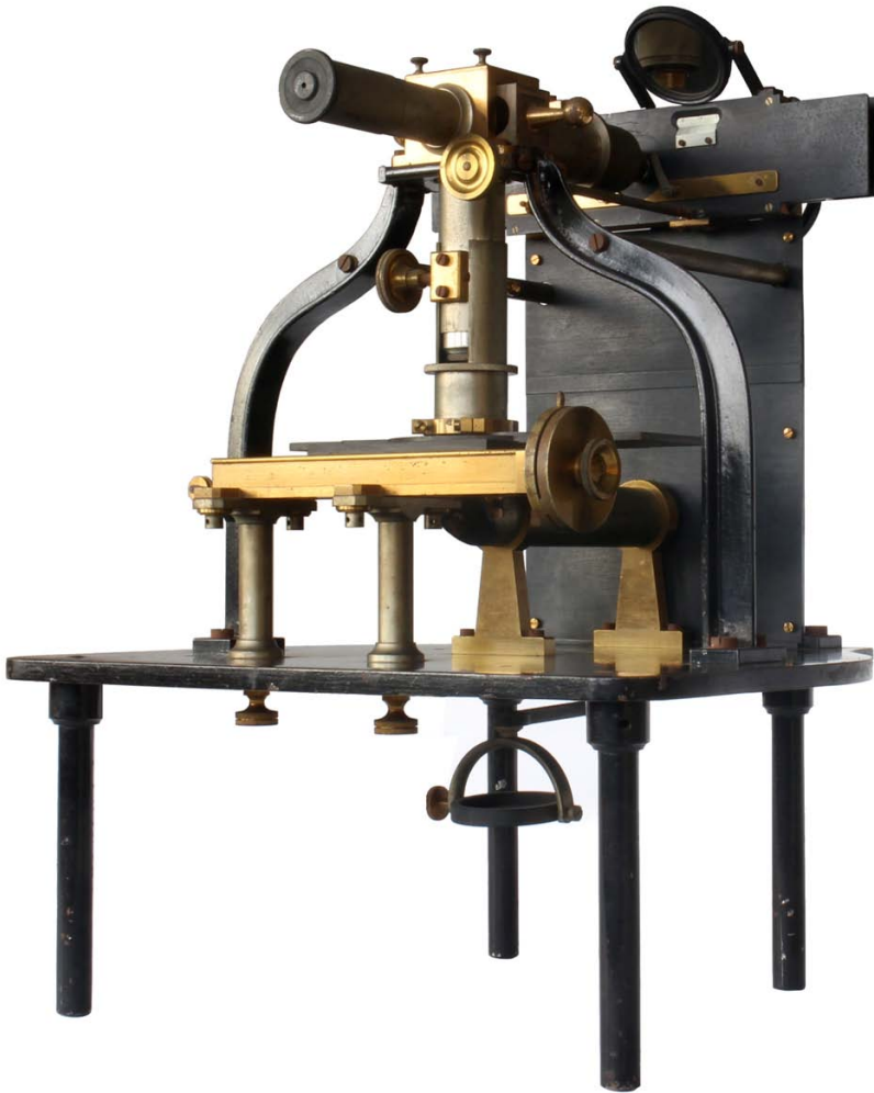
Abb. 8. Mikrophotometer nach Hartmann von Otto Toepfer Potsdam, um 1905. Mikrophotometer sind Kombinationen von Mikroskop und Photometer, mit denen die Schwärzung S = \log(1/T) einer Photoplatte quantitativ gemessen werden kann, wobei T die Transparenz der photographischen Schicht bezeichnet ( T = 0 : „völlig schwarz“, T = 1 : „klarer Film“). Das Mikrophotometer gestattet die genaue Bewegung und Positionierung der Photoplatte sowie die Messung der Transparenz mit Hilfe einer elektrisch regelbaren Vergleichslichtquelle. Die gemessenen Schwärzungen werden mit Hilfe der Schwärzungskurve der betreffenden Platte in Intensitäten bzw. Sternhelligkeiten umgerechnet. Das hier gezeigte Mikrophotometer wurde um 1905 von Otto Toepfer in Potsdam hergestellt. Es beruht auf einer Konstruktion von Johannes Hartmann (1865–1936) und wird deshalb auch „Hartmann-Photometer“ genannt. Es gelangte 1909 mit dem Wechsel von Hartmann vom Astrophysikalischen Observatorium in Potsdam nach Göttingen (Sammlung historischer Gegenstände am Institut für Astrophysik der Georg-August-Universität Göttingen, Objektnummer A208, Foto: K. Reinsch).
