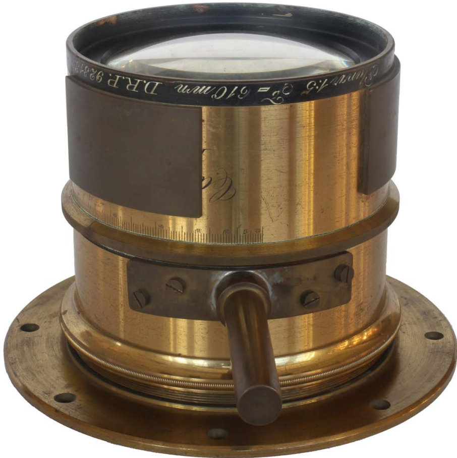
Abb. 3. 6-linsiges photographisches Objektiv der Firma Carl Zeiss („Zeiss Planar“). Das 1897 von der Firma Carl Zeiss zum Patent angemeldete „Planar“ ist ein hochwertiges photographisches Objektiv, das ursprünglich auf eine von Carl Friedrich Gauß erfundene 4-linsige Konstruktion zurückgeht, die bei Zeiss auf ein 6-linsiges Objektiv erweitert wurde. Es ist mit einer verstellbaren Ringblende ausgestattet und liefert nahezu fehlerfreie und unverzerrte Abbildungen (daher „Planar“). Hier gezeigt ist eine Objektivlinse mit Metall-Diaphragma (verstellbare Ringblende) in Messingfassung, Öffnung ca. 12 cm, Brennweite 61 cm, Prägung: „Carl Zeiß, Planar 1:5, F=610 mm, D.R.P. [Deutsches Reichspatent] 92313, Serie Ia, No. 18; No. 22351“ (Sammlung historischer Gegenstände am Institut für Astrophysik der Georg-August-Universität Göttingen, Objektnummer A205, Foto: K. Reinsch).
