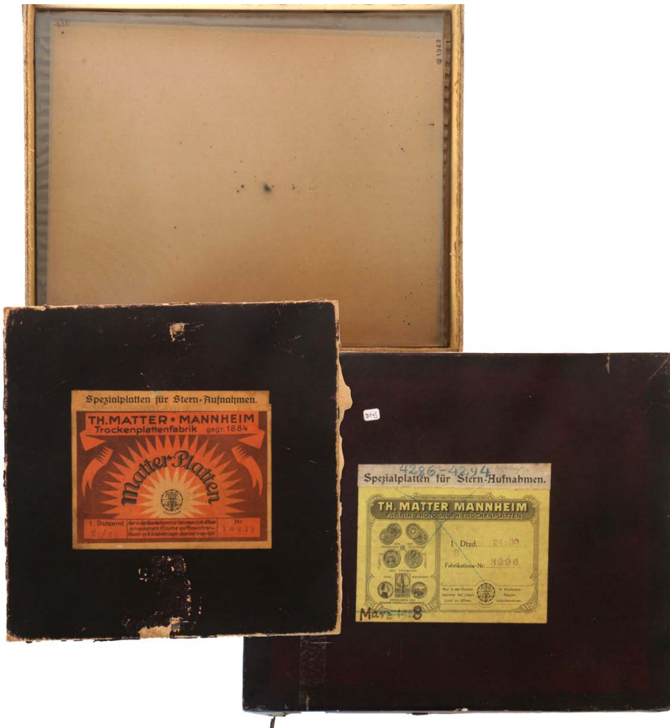
Abb. 5. Trockenplatten. Das um 1870 entwickelte „trockene Gelatineverfahren“ ersetzte in vielen Bereichen der photographischen Astronomie das bisherige „nasse Kollodiumverfahren“, denn es ermöglichte um einen Faktor 10 kürzere Belichtungszeiten und damit die Aufnahme lichtschwacher Sterne. Zudem waren die Platten von gleichbleibender Qualität, gut transportabel und lange lagerfähig. Das Bild zeigt eine belichtete Originalplatte nebst Kartondeckelfragmenten mit Aufkleber: „Spezialplatten für Sternaufnahmen TH. MATTER MANNHEIM. . .“ der Firma August und Theodor Matter in Mannheim. August Matter unterstützte um 1920 die Astronomen in Heidelberg kostenlos mit Trockenplatten. Nach ihm ist der Kleinplanet „883 Matteriana“ benannt (Sammlung historischer Gegenstände am Institut für Astrophysik der Georg-August-Universität Göttingen, Objekt Nummer A377, Foto: K. Reinsch).
