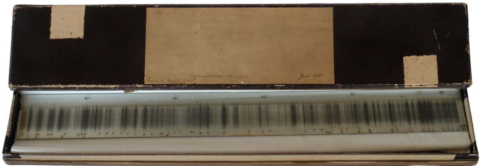
Abb. 6. Photographische Originalplatten „Bogenspektrum des Eisens“, 1903. Mit der Einführung der Spektralanalyse und der photographischen Spektroskopie in die Astronomie in der zweiten Hälfte des 19. Jahrhunderts wurde es erstmals möglich, physikalische Eigenschaften entfernter astronomischer Objekte zu untersuchen. Dabei werden zur Wellenlängenkalibrierung mit derselben Messapparatur aufgenommene Spektren aus dem Labor bekannter Lichtquellen, wie z.B. Bogenlampen, benötigt. Die hier gezeigten Originalglasplatten entstammen einem wahrscheinlich von Schwarzschild beschrifteten Pappkasten „Bogenspektrum des Eisens. Rowlands Concav-Gitter. Juni 1903“ (Sammlung historischer Gegenstände am Institut für Astrophysik der Georg-August-Universität Göttingen, Objekt Nummer A248, Foto: K. Reinsch).
