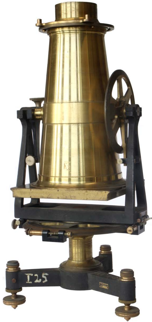
Abb. 10. Zenitkamera aus dem Bestand des ehemaligen Reichs-Kolonialamtes. Eine Zenitkamera registriert auf einer Fotoplatte den Durchgang von Sternen in einem engen Bereich um den Zenit (d.h. genau senkrecht über dem Beobachter) in Form von parallelen Strichspuren. Daraus kann bei Kenntnis der Brennweite der Kamera und der Deklination der Sterne die geographische bzw. astronomische Breite und die Polhöhe am Beobachtungsort bestimmt werden. Die hier gezeigte Zenitkamera aus Messing mit einer Plattengröße 15 cm x 15 cm und dreibeinigem Stativ gelangte aus dem Bestand des ehemaligen Reichs-Kolonialamtes in den Besitz der Göttinger Sternwarte. Der von Karl Schwarzschild entwickelte Aufbau einer hängenden Zenitkamera ist nicht erhalten (Sammlung historischer Gegenstände am Institut für Astrophysik der Georg-August-Universität Göttingen, Objekt Nummer A264, Foto: K. Reinsch).
