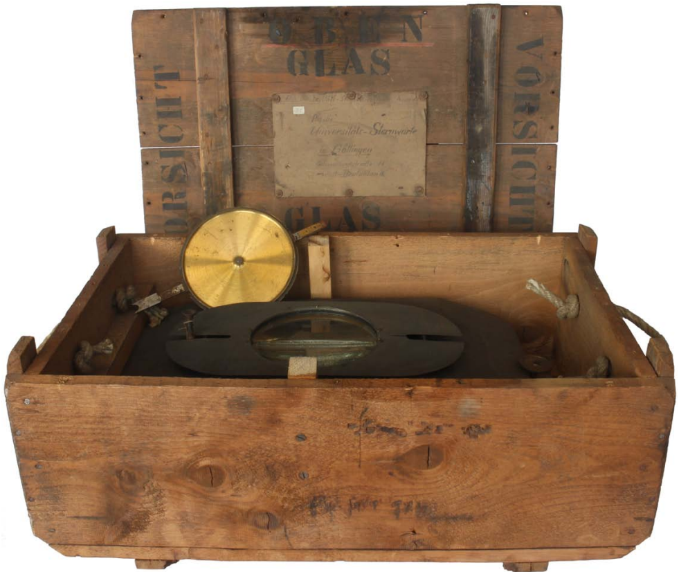
Abb. 4. Heliometerobjektiv von Reinfelder & Hertel München, ca. 1888. Mit einem Heliometer (genauer: Objektivheliometer) können kleine Winkelabstände am Himmel präzise gemessen werden. Dazu ist seine Objektivlinse in zwei Hälften geteilt, die jede für sich ein vollständiges Bild der Objekte im Gesichtsfeld liefert. Durch messbares Verschieben der beiden Hälften werden die Bilder zweier eng benachbarter Sterne (oder auch zweier gegenüberliegender Ränder der Sonnenscheibe) aufeinander geschoben und durch Ablesung der Mikrometerschrauben deren Winkelabstand gemessen. Hierbei handelt es sich um das Objektiv des von 1888 bis 1926 in der Kuppel der Göttinger Sternwarte aufgestellten Repsold'schen Heliometers mit einer Öffnung von 16,2 cm und einer Brennweite von 262 cm (Sammlung historischer Gegenstände am Institut für Astrophysik der Georg-August-Universität Göttingen, Objekt Nummer A325, Foto: K. Reinsch).
