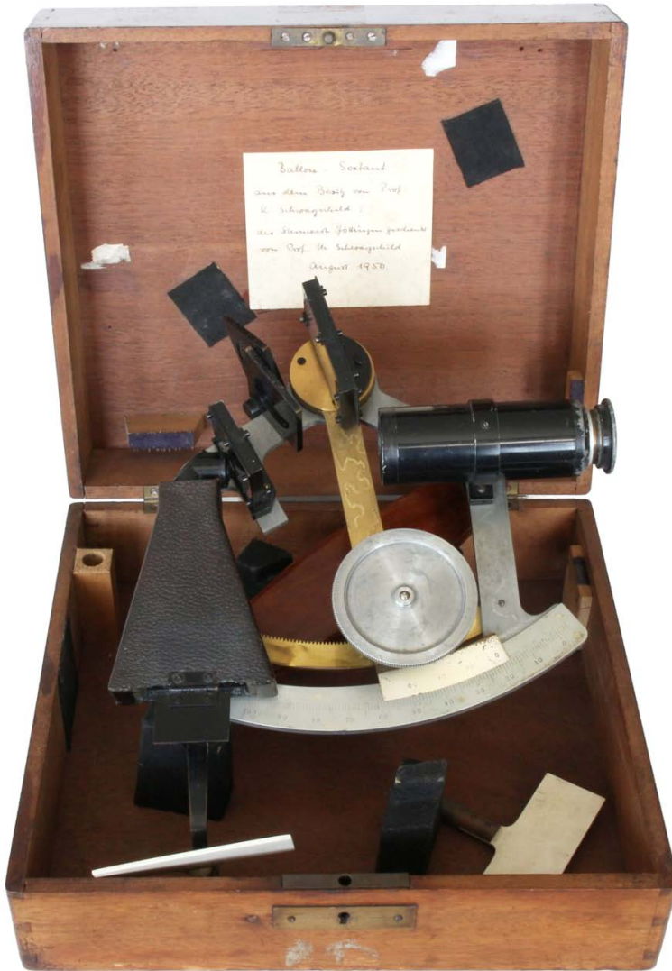
Abb. 1. Ballonsextant nach Karl Schwarzschild, hergestellt von Spindler & Hoyer Göttingen. Beim Flug mit einem Ballon oder auch einem Zeppelin ist der Horizont nicht nur um die sog. „Kimmtiefe“ abgesenkt, sondern nachts der Dunkelheit wegen auch unsichtbar. Schwarzschild hat daher 1910 einen mit einem künstlichen Libellenhorizont, der durch elektrische Glühlämpchen beleuchtet wurde, versehenen Sextanten erfunden, um vom Ballon aus sowohl tagsüber als auch zur Nachtzeit astronomische Ortsbestimmungen zu ermöglichen. Das hier gezeigte Exemplar wurde 1950 der Göttinger Sternwarte durch dessen Sohn Martin Schwarzschild geschenkt (Sammlung historischer Gegenstände am Institut für Astrophysik der Georg-August-Universität Göttingen, Objekt Nummer A066, Foto: K. Reinsch).
