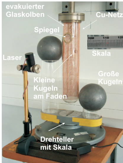
Bild 1.1: Gravitationswaage (links: Aufbauten I, II, III; rechts: Aufbauten IV und V) bestehend aus zwei an einem Torsionsfaden aufgehängten kleinen Kugeln in einem evakuierten Gefäß, mit einem Spiegel am Faden. Der Spiegel wird mit einem Laser beleuchtet und auf einer gegenüberliegenden Skala abgebildet. So wird die Torsion des Fadens sichtbar.
