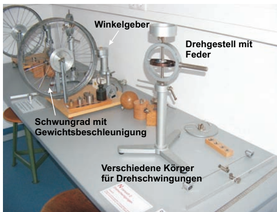
Bild 3.1: Versuch Messung von Trägheitsmomenten verschiedener Körper.
