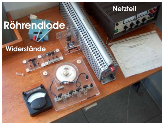
Bild 20.1: Ein Bild des Versuchs »Diode«.
