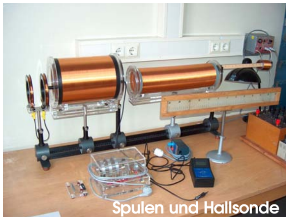
Bild 14.1: Der Versuch »Magnetfelder von Spulen«.
