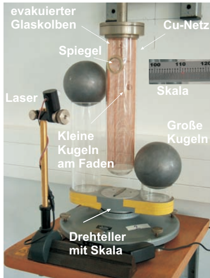
Bild 2.1: Gravitationswaage bestehend aus zwei an einem Torsionsfaden aufgehängten kleinen Kugeln in einem evakuierten Glaskolben, mit einem Spiegel am Faden und einem umgebenden Kupfernetz. Der Spiegel wird mit einem Laser beleuchtet und auf einer gegenüberliegenden Skala abgebildet. So wird die Torsion des Fadens sichtbar.
