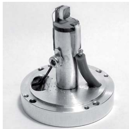
Abbildung 2.21: Probenhalterung mit kontaktierter Probe und Zugentlastung.
