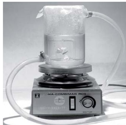
Abbildung 2.19: Kristallzucht aus wässriger Lösung in temperierten Gefäßen.
