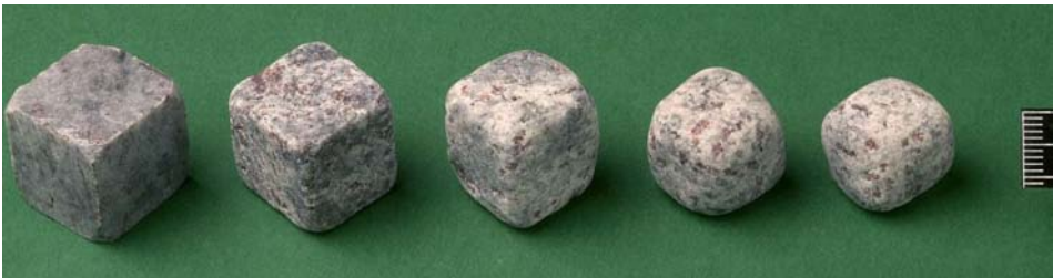
Abb. 1: Ergebnisse eines Abrasionsversuches mit Granitproben in Straußenmägen. Der Stein am linken Bildrand zeigt den ursprünglichen, gesägten Zustand bei der Verfütterung (freiwillige Steinaufnahme durch die Tiere). Am rechten Bildrand ist der Zustand der Proben am Ende der Versuchsreihe nach 50 Tagen zu sehen. Der Gewichtsverlust der Steine in diesem Zeitraum betrug ca. 50 %.
