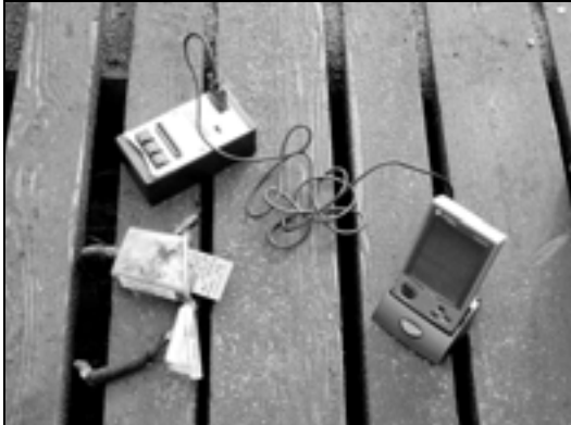
Abb. 1: Die Daten werden mit einem Pocket-PC (rechts), der an einer Dockingstation (links oben) angeschlossen ist, vom Zählgerät (links unten) herunter geladen. Foto: Wendt
