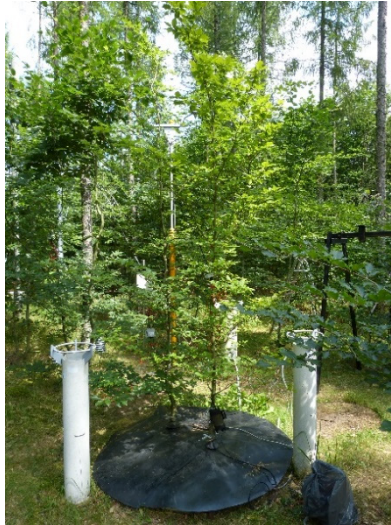
Abbildung 6: WKL mit Abdeckhaube zur Ermittlung der Trockenstresswirkung auf das Wachstum junger Buchen
