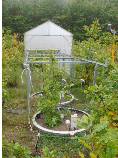
Abbildung 5: WKL mit fahrbarem Dach zur Ermittlung des Wasserverbrauchs junger Eichen
