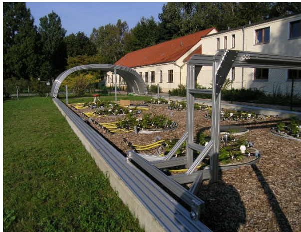
Abbildung 8: Drylab mit acht Lysimetern, fahrbarem Dach und installierter Tropfenbewässerung
