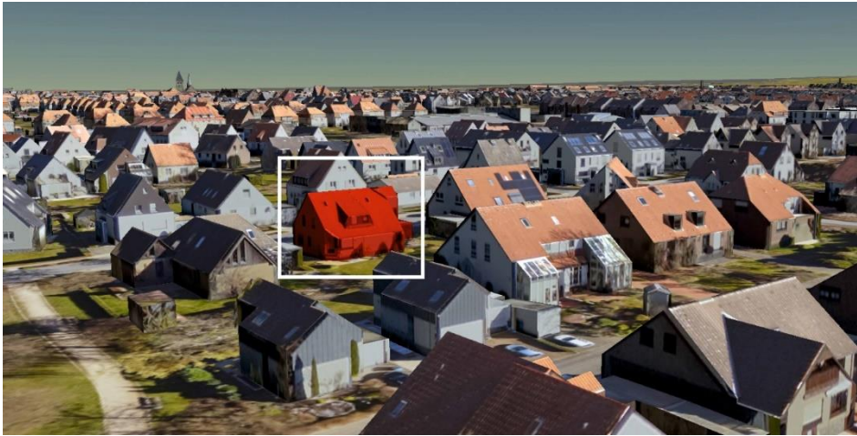
Abb. 7: Ausschnitt aus dem fotorealistisch texturierten Stadtmodell der Stadt Soest mit unterlegtem Luftbild. Einzelne 3D-Gebäude können selektiert (weißes Rechteck) und heruntergeladen werden. (Quelle: https://soest.virtualcitymap.de/#/ ; http://www.govdata.de/dl-de/zero-2-0 )
